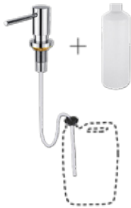
Dávkovač tekutého mýdla, gelu Hlava pumpy průměr 35 mm. Mosaz. Chrom. Plnění 350 ml nádobky shora vyjmutím pumpy.
